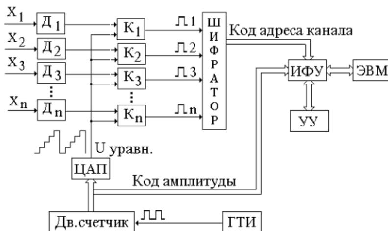
Рис. 2. Структурная схема мультиплицированной ИИС
